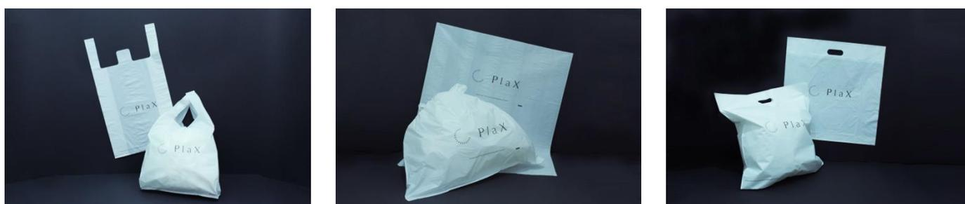
Plax の技術を応用して生分解性樹脂と石灰石を配合した、これまでにない新しい袋です。コンポスト環境下で石灰石と水と二酸化炭素に分解され、環境汚染問題に貢献することができます。比較的、硬質なバイオ樹脂、ポリ乳酸を主原料としながら柔軟性がある手触りです。
