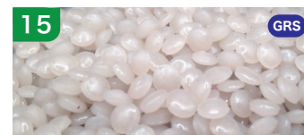
15 LDPE マレーシア フィルム由来 透明 PCR 26t/月 120メッシュ MFR1.25
