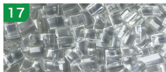
17 PET 関東エリア 食品容器由来 透明 PIR 13t/月 150メッシュ MFR準備中
