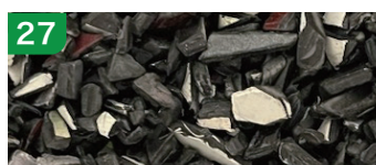
27 PP 東海エリア バンパー(塗装付)由来 雑色 PIR 月10t MFR準備中 10mm
